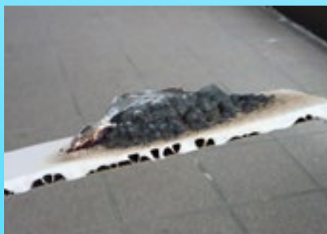
④最終的に約40倍に膨張し、断熱性に優れた炭化層を形成する 10分間の燃焼後でも、裏面には何ら痕跡無し
